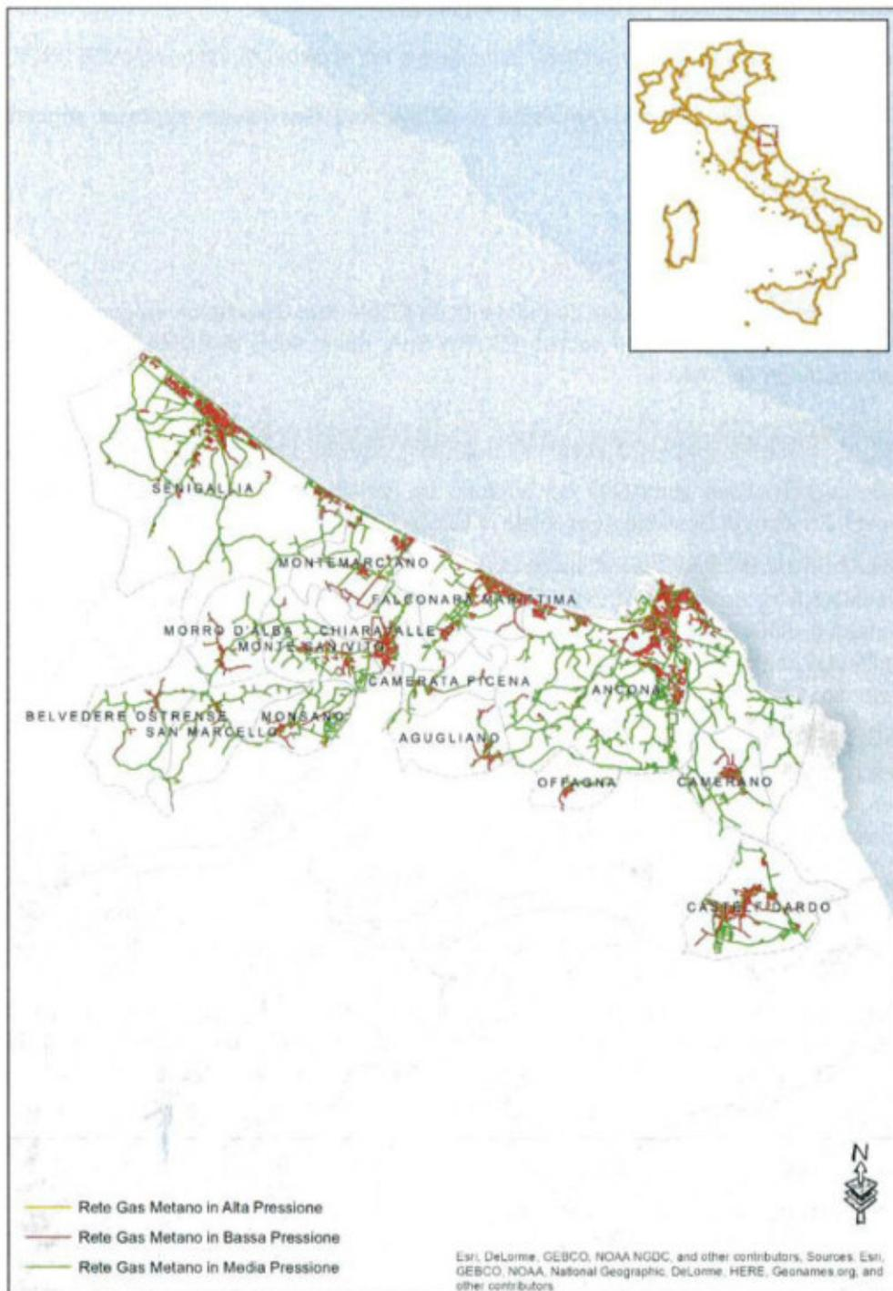
Figura 13 – Rappresentazione della rete di distribuzione gas di EDMA Reti Gas
